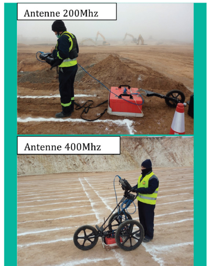
Figure 04: Equipements utilisés pour l'investigation Géoradar
